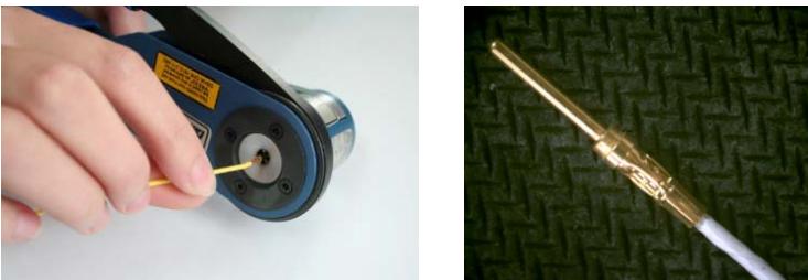
图 7 导线压接示意图
