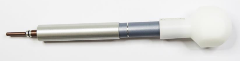
图 D.2 插针接触件保持力测试工具
