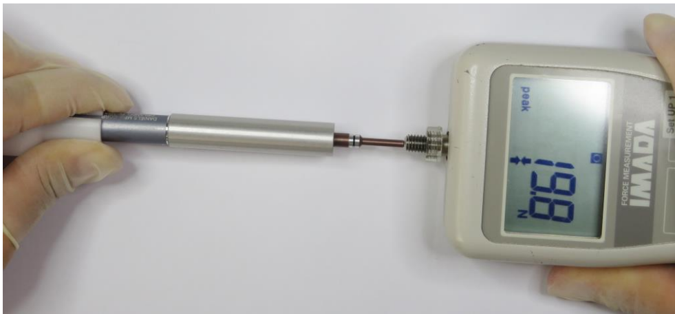
图 D.5 专用测试工具调试保持力的示意图
