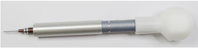
图 D.3 插孔接触件保持力测试工具
