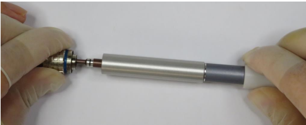
图 D.6 保持力测试示意图
