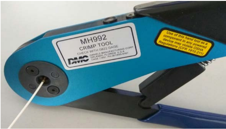
图 D.6 导线压接示意图
