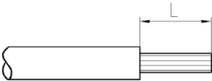
图 D.4 导线剥线示意图
