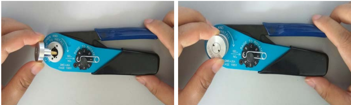
图D.2 轴向定位器安装示意图
