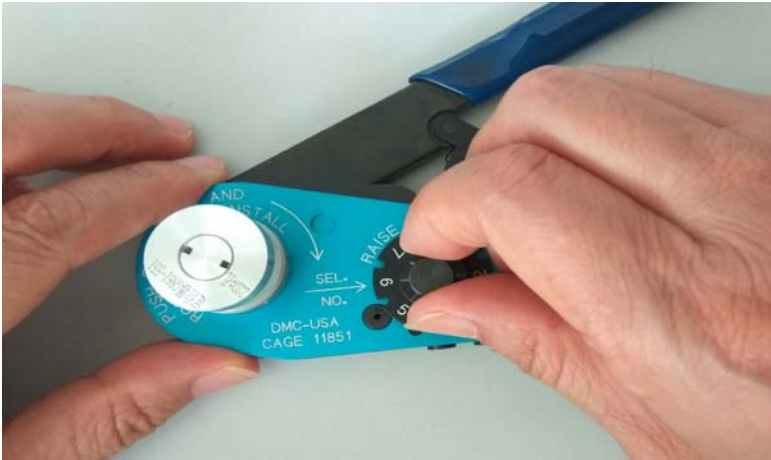
图D.3 径向定位器选择操作示意图
